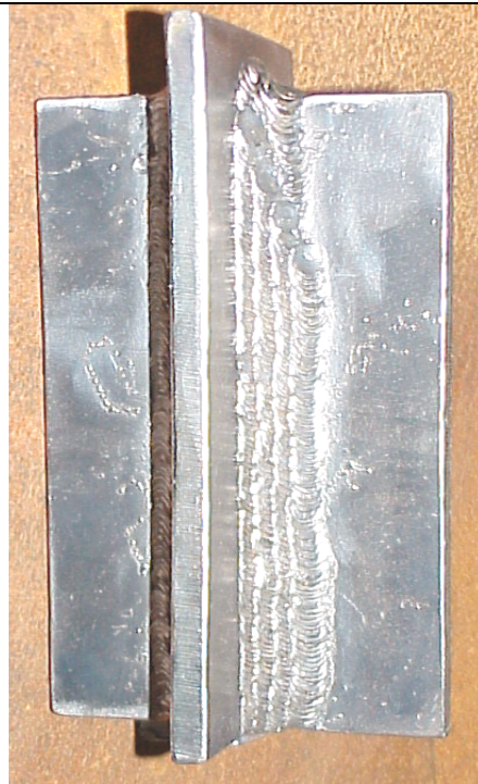
Vertical Up T-Joint
